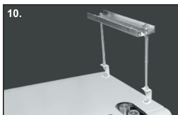
10. Sollevare quindi la barriera e infilare i supporti scorrevoli nei supporti fissati al muro o al soffitto. Verificare che la barriera sia in bolla orizzontalmente sia in lunghezza che in profondità, dopodiché inserire e stringere le viti di sicurezza precedentemente rimosse.
