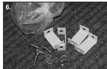
6. Preparare il materiale di fissaggio: - 4 bulloni M8 - 4 staffe a C - 8 rondelle (4 piane 4 elastiche)
