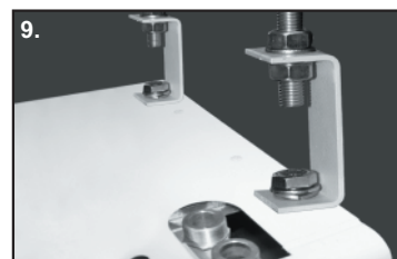
8. Tagliare le barre filettate alla giusta lunghezza, se necessario, e avvitarle nei filetti presenti sul supporto scorrevole; bloccarle con un controdamo sotto il supporto. Fissare la barra filettata alla staffa sulla barriera. Ripetere la procedura per tutte le barre filettate. In caso di due barriere affiancate il supporto scorrevole centrale è predisposto per ricevere 4 barre filettate, due per ogni barriera.
