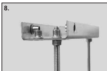
8. Tagliare le barre filettate alla giusta lunghezza, se necessario, e avvitarle nei filetti presenti sul supporto scorrevole; bloccarle con un controdamo sotto il supporto. Fissare la barra filettata alla staffa sulla barriera. Ripetere la procedura per tutte le barre filettate. In caso di due barriere affiancate il supporto scorrevole centrale è predisposto per ricevere 4 barre filettate, due per ogni barriera.
